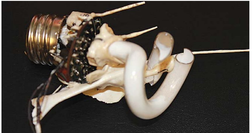
Miembro de la cooperativa arrancaron esta bombilla CFL derretida al lado de su horno. Sustitución general utilice bombillas CFL eficientes de ahorra energía LED, pero no todos los trabajos de bulbo bajo temperaturas extremas. Fuente: Empire electric Association, CO.
